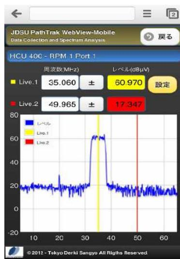
PathTrakモバイルアプリケーションはVIAVI社上り流合雑音監視装置PathTrakに、モバイル端末での簡易スペクトラム表示機能を加えるアプリケーション・ソフトウェアです。
