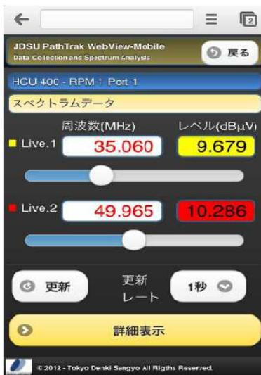
● 流合雑音監視システムPathTrak の上リスペクトラム表示をモバイル端末で簡易閲覧可能
